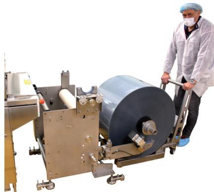
Mise en place de la bobine sur la machine.
