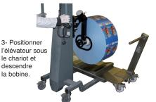
Faire tourner la bobine dans la bonne position et transférez-la derrière la Thermoformeuse
